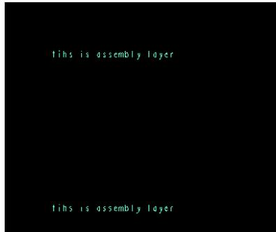
说明：这里只显示装配顶层有两个原因，第一，生成变体装配图的时候是依据视图中显示了哪些信息来决定把哪些对象放置在变体装配图中，如果在生成变体装配图的时候显示的有丝印层的信息，那么最后生成的变体装配图中就会包含丝印层的信息。显然我们只需要装配层的信息，其他层的信息在这个时候就是干扰，所有我们只显示 assembly 层（装配层）的信息。第二，生成变体装配图的时候是分开两次显示的，一次 top 层，一次 Bottom 层，所以我们以 top 层为例，只显示 assembly top 的信息。
