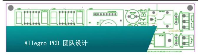
Allegro 产品包中 Allegro Partitioning Option 是一种用于 PCB 团队合作设计的功能模块,它可将一块复杂 PCB 板分成多个简单的 PCB 板,通过团队合作设计,合并设计的方法,可以大大提升设计效率,缩短设计周期。如下图所示:
