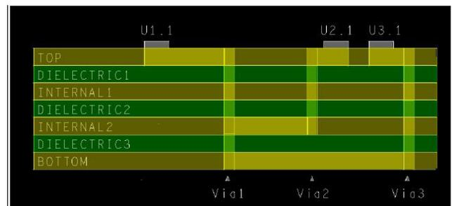
在上图中 U1.1 同时连接到 U2.1 和 U3.1 通过一个 T 点，这个 T 点以一个 Via(Via1)来实现，U1.1 到 U2.1 通过了 Via1 和 Via2；U1.1 到 U3.1 通过了 Via1 和 Via3。计算到 T 点的距离时，作为 T
